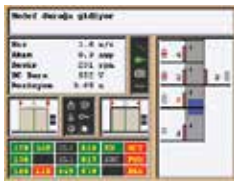
Kabin pozisyonu kapı durumu ve iç-dış kayıtlar hakkında bilgi verir Information on car position, door status, car commands and landing calls
